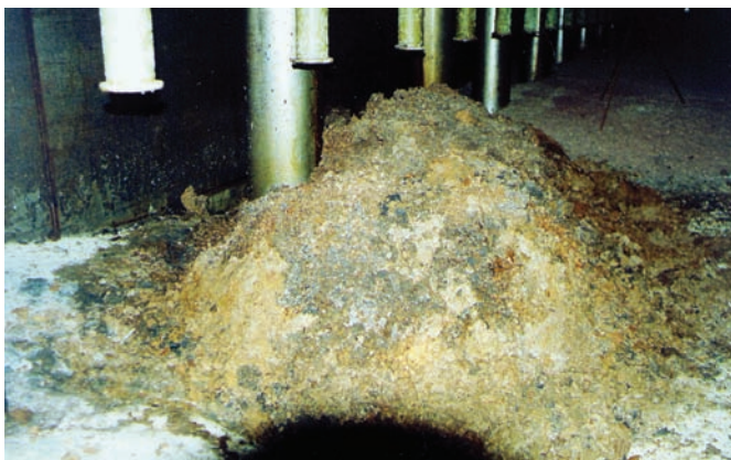
Bild 07: Brennstoffhaltige Materialien im Inneren des havarierten Blocks 4
