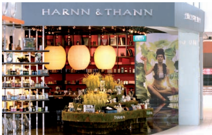
Bild 2. In den Shops punktet das brillante Licht von Halogen-Metaldampflampen, betrieben an Vorschaltgeräten PTi 1x35W von OSRAM
