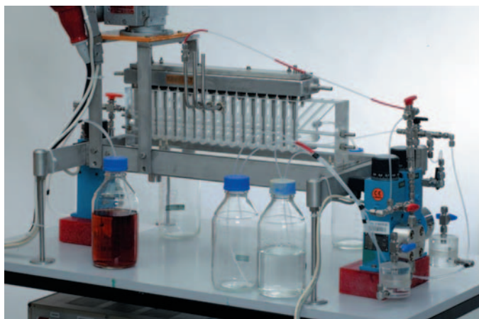
In solchen Apparaturen, die in der Fachsprache „Mixer-Settler“ heißen, laufen die Jülicher Experimente zur Trennung von Neptunium, Americium und Curium von den Lanthanoiden ab.
