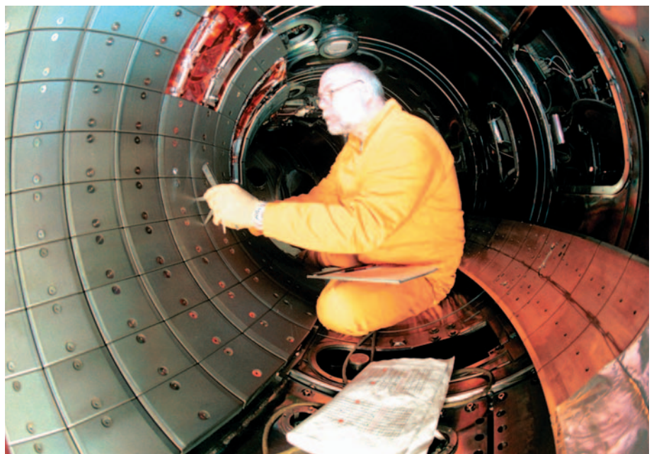
Ein Techniker befestigt Graphitplatten im Jülicher TEXTOR.
