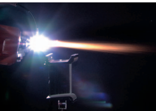
Mit der Fackel eines Plasmabrenners trägt man Schutzschichten auf. Ihr wird ein keramisches Pulver beigelegt, das schmilzt und sich dann auf dem Werkstück absetzt.
