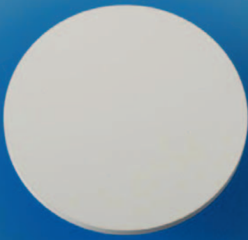
Unscheinbare Hoffnungsträger: Der Jülicher Prototyp einer keramischen Membran, die Gase effizienter voneinander trennt als chemische Verfahren.
