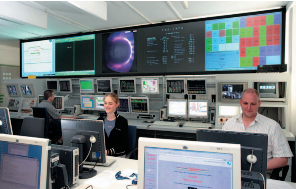
Die Steuerzentrale von TEXTOR. Von hier aus lenken und überwachen die Wissenschaftler die Fusionsexperimente.
