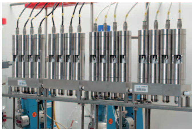
Solche Zentrifugalextraktoren ermöglichen die Flüssig-Flüssig-Extraktion auch dann, wenn die Dichteunterschiede zwischen den beiden Lösemitteln gering sind.
