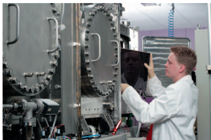
In einer so genannten PEVCD-Anlage (für: Plasma Enhanced Chemical Vapour Deposition) werden die Siliziumschichten aufgedampft. Ein Techniker entnimmt die beschichtete Platte.
