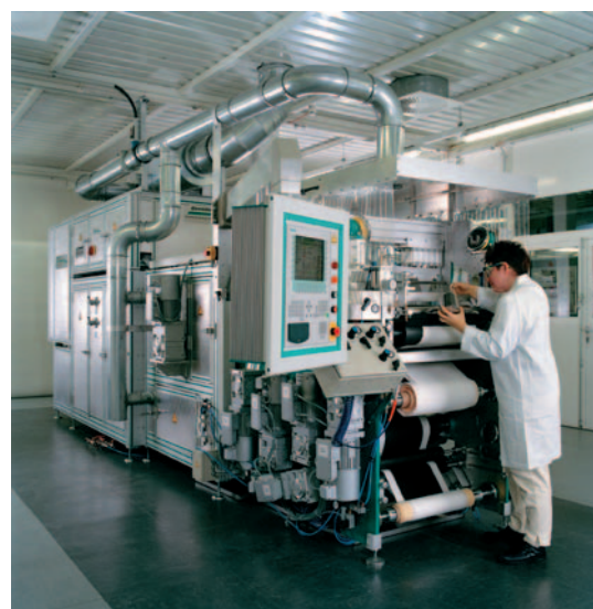
Elektroden am laufenden Band: Die Deskcoater-Maschine wurde ursprünglich entwickelt, um Textilien zu beschichten. Nach einer Umrüstung dient sie nun Jülicher Wissenschaftlern dazu, Komponenten der Membran-Elektroden-Einheiten von Brennstoffzellen kostengünstig und in hoher Qualität zu produzieren.
