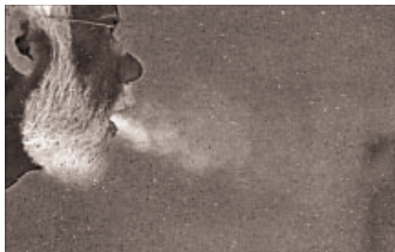
Fig. 4: \text{CO}_2 contained in the breath of a person is visualized in the subtraction image of the MWIR 288x384 dual-color superlattice camera (red channel minus blue channel). Abb. 4: Das in der Atemluft enthaltene \text{CO}_2 kann im Differenzbild (roter Kanal minus blauer Kanal) einer 288x384-Zwei-Farben-Übergitter-Kamera dargestellt werden.
