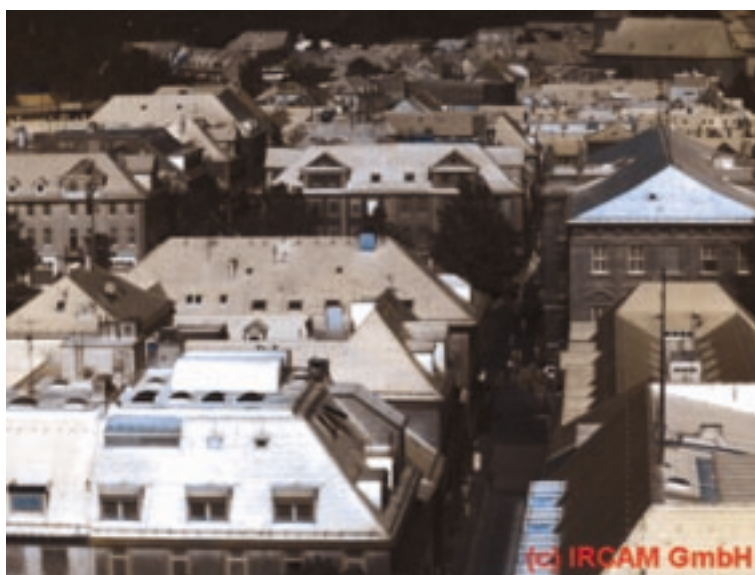
Fig. 1: Fused complementary color image, taken with the 288x384 dual-band QWIP camera. Complementary colors blue and orange have been used to superimpose the MWIR and LWIR channel, respectively, in one image. Abb. 1: Aufnahme mit einer 288x384-Zwei-Band-QWIP-Kamera, wobei die Daten des MWIR- und LWIR-Kanals in den Komplementärfarben blau bzw. orange überlagert in einem Bild dargestellt wurden.
