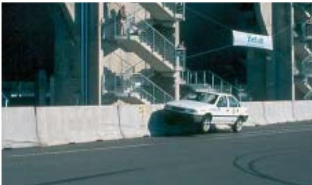
Bild 1: PKW-Anfahrt an eine Betonschutzwand
