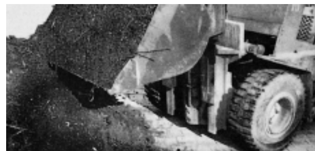
Bild 1: Umsetzen einer Kompostmiete auf einer belüftbaren Betonfläche, System Schwenk
