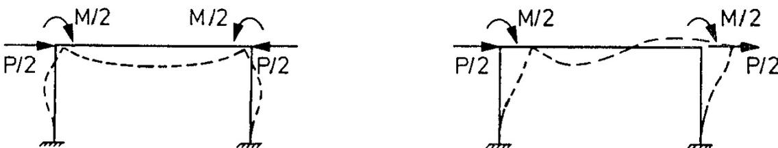
Abbildung 6.13: Verformungsfiguren unter symmetrischer und antimetrischer Belastung
