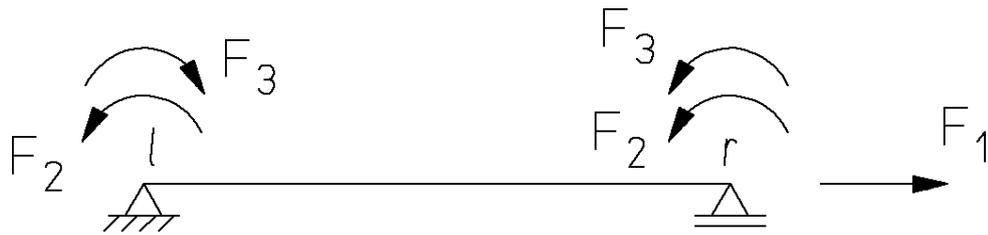
Abbildung 3.7: Mögliche linear unabhängige Stabendkräfte eines ebenen Stabelementes
