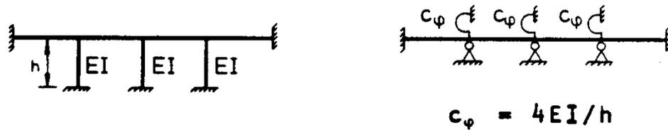
Abbildung 10.6: Rahmentragwerk mit Idealisierung als Durchlaufträger unter Vernachlässigung von Normalkraftverformungen
