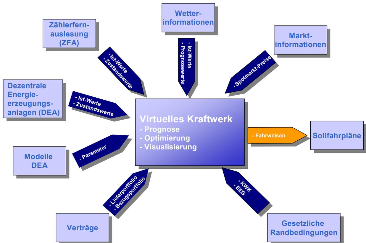
Bild 1: Informationsfluss innerhalb eines Virtuellen Kraftwerks
