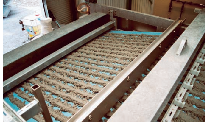
Abb. 7: Schlamm in der Siebbandpresse
