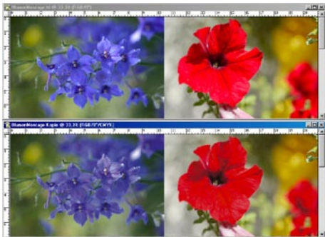
Die Softproof-Darstellung ermöglicht die Vorschau auf die Druckausgabe bereits auf dem Monitor.
