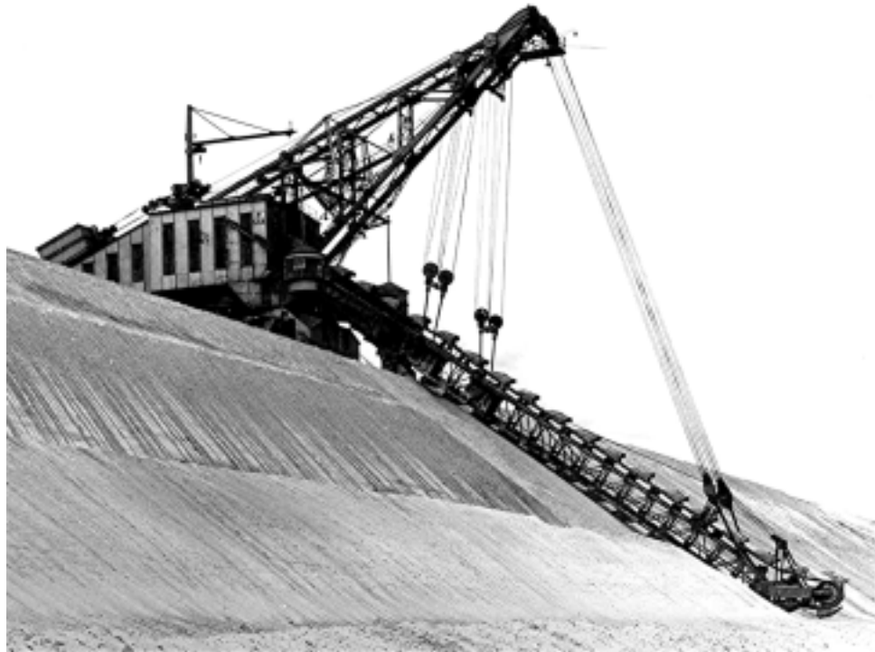
Bild 29: Der größte Eimerkettenbagger der Welt im Jahre 1932 (RWE Power AG)
