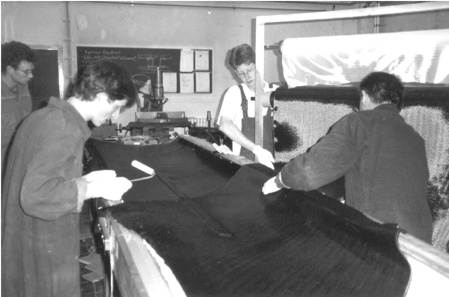
Bild 2: Kohlegewebe wird in die Form der Oberschale der Tragfläche eingelegt
