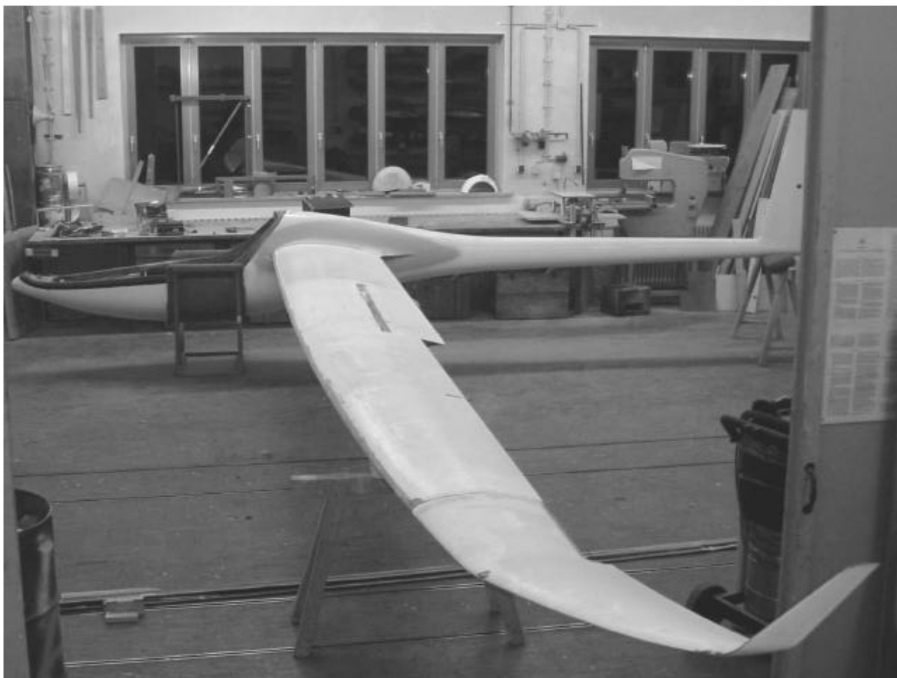
Bild 4: Linke Tragfläche mit Winglets, allerdings ohne Querruder, in den Rumpf der AK-8 eingesteckt. An der Fläche sind noch Feinarbeiten zu leisten, um sie schließlich lackieren zu können.
