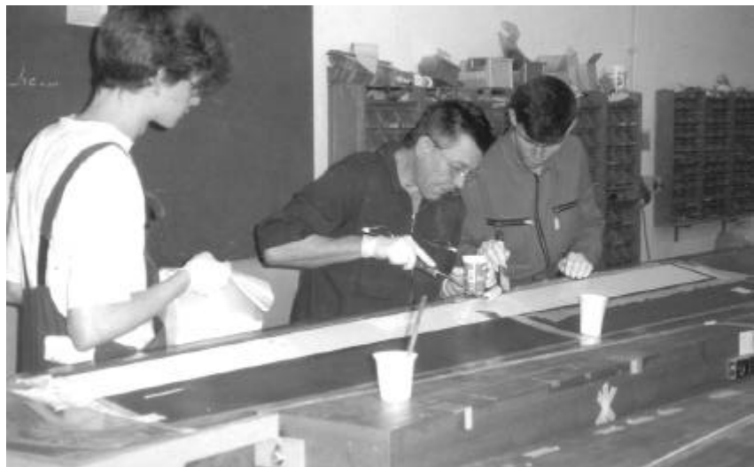
Bild 1: Tobias, Chris und Burkard legen die erste Glasgewebelage für das Querruder in die Form ein.
