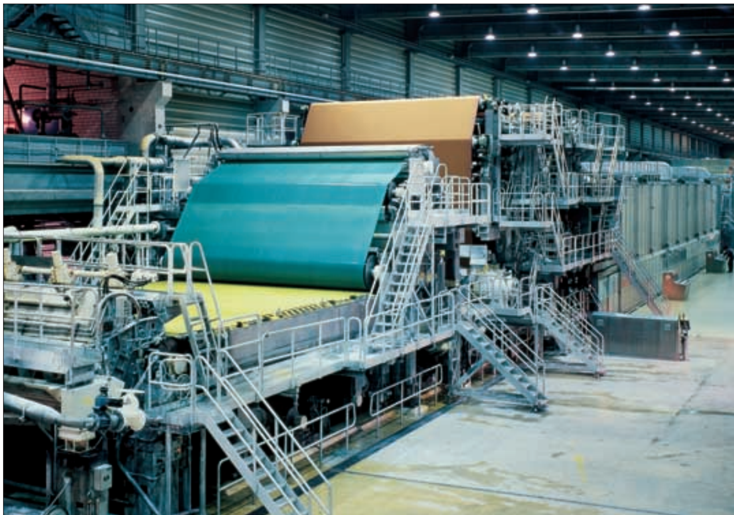
Papiermaschine für die Produktion von SD-Papieren im Mitsubishi Werk Hillegossen
