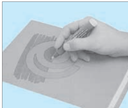
Prüfung einer neutralisierten Fläche
