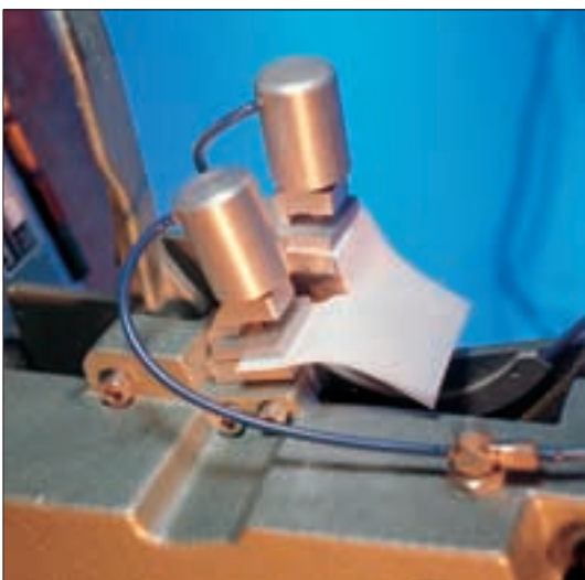
Messung der Weiterreißfestigkeit
