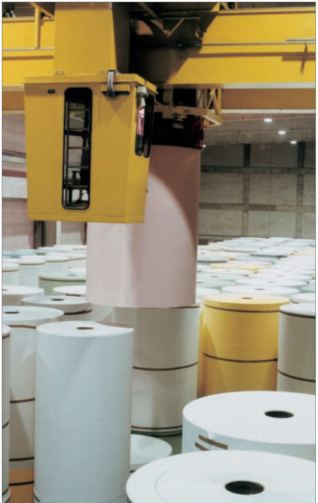
Computergesteuertes Lager für Giroform SD-Papiere im Mitsubishi Werk Hillegossen
