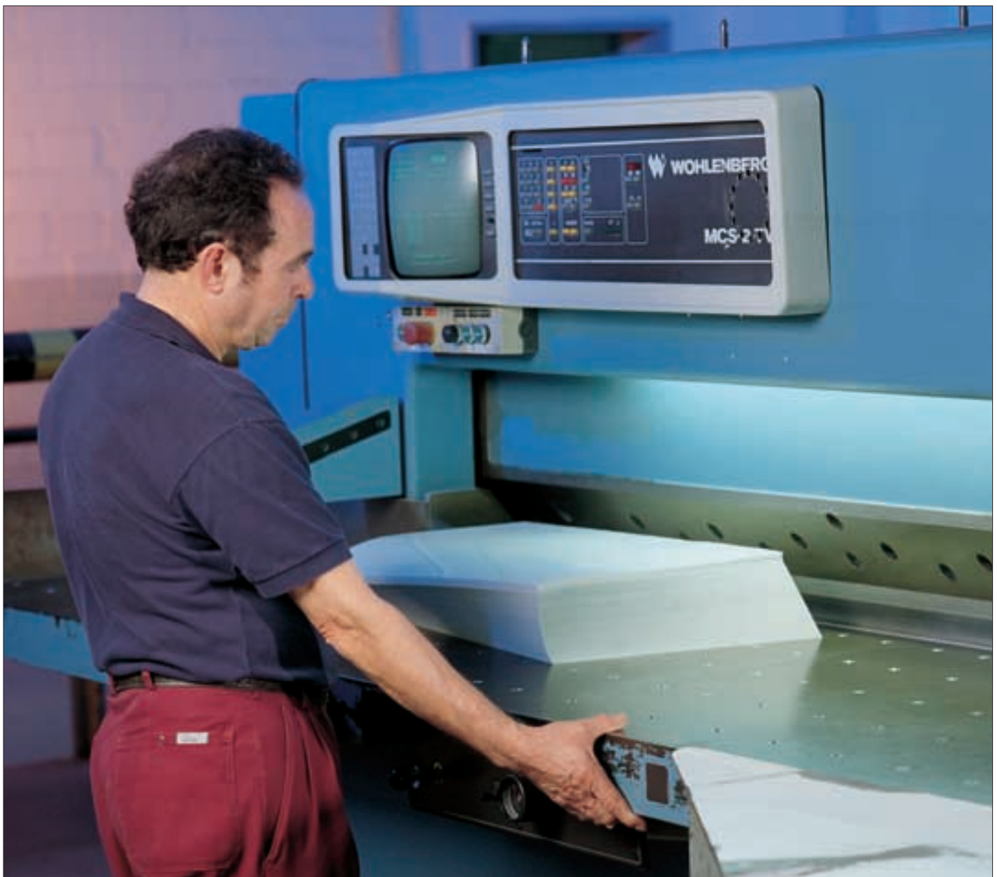
Schneiden von Druckbogen
