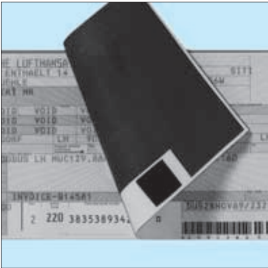
Heißkarbondruck auf Flugtickets
