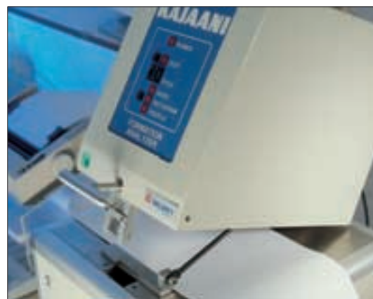
Bestimmung des Formationswertes
