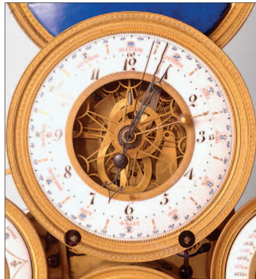
Abb. 2 Mittleres Zifferblatt: Tag, Monat, mittlere Zeit mit Minuten und Sekunden, Sonnenzeit.
