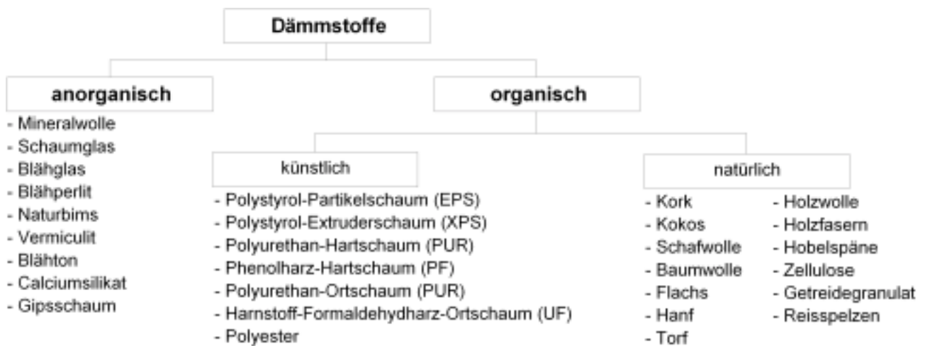
Bild 2.2-1: Systematik der Dämmstoffe nach ihrer Rohstoffbasis
