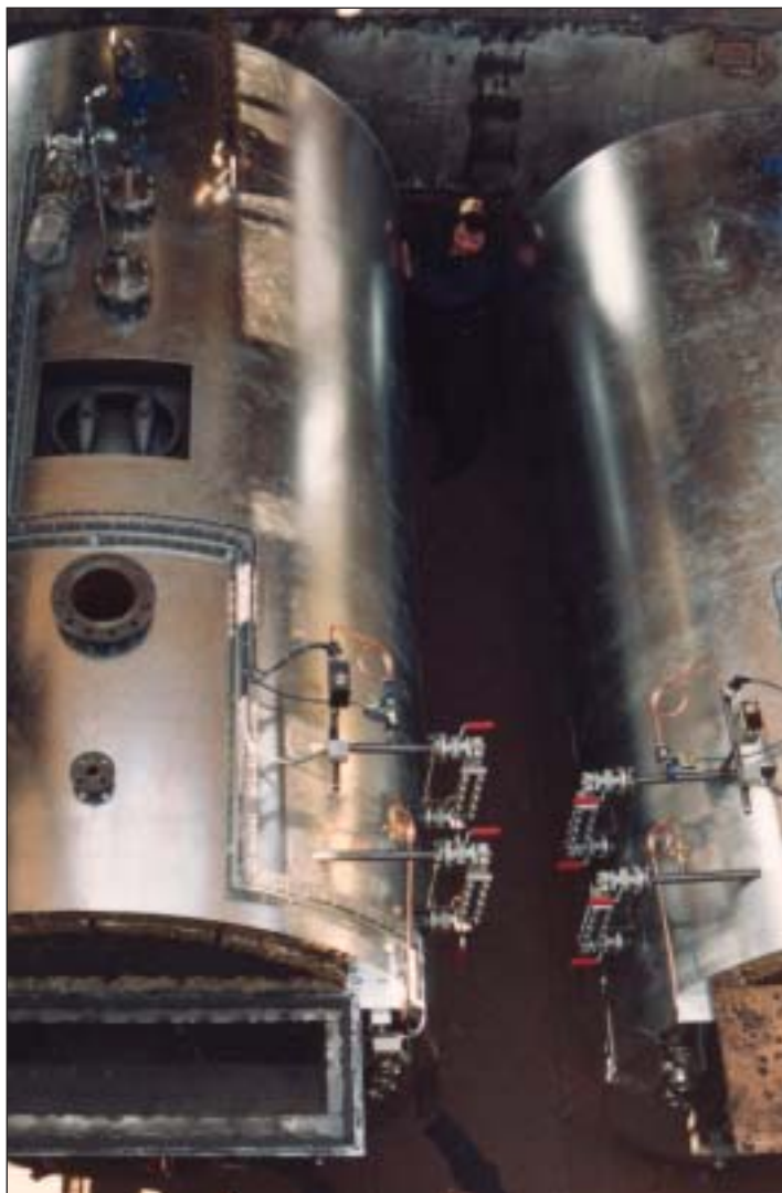
Doppelte Power: Die Original-Dampfmaschine von 1913, die die Schaufelräder antreibt, wird von diesen neuen Kesseln mit Dampf versorgt. Die Maschinenleistung von 700 PS bringt den Dampfer auf 16 km/h (stromaufwärts)
