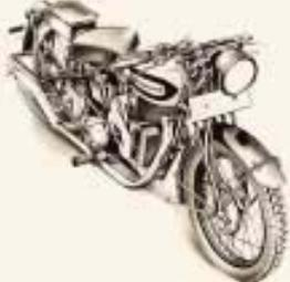
Sunnqvist schlägt sensationell beim Avus-Hochgeschwindigkeitsrennen die Kompressor-BMW und Werks-DKW. Eine der zuverlässigsten und besten Vorkriegs-Serienmaschinen: das Modell 112 TV mit 24 PS aus 496 cm³
