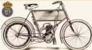
Aus Fahrradteilen und einem FN-Motor mit 1,25 PS entsteht das erste Motorrad
